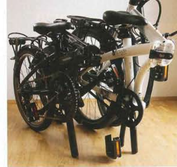
Die beiden Testräder gefaltet: kaum ein Unterschied trotz differierender Laufradgrößen
