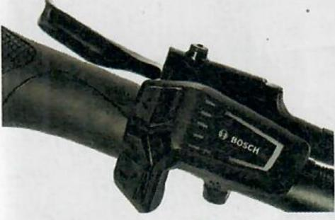
Einfache Motor-Ansteuerung: das Bedienpanel am linken Griff.
