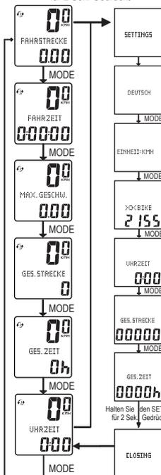
Halten Sie RESET (4) für 2 Sekunden gedrückt, um Wegstrecke, Wegzeit, und maximale Geschwindigkeit auf 0 zurückzusetzen
